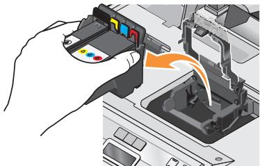
**3** 使用干净且不掉毛的软布擦洗打印头触点。
